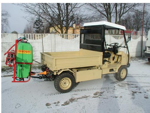
Si tratta di un **veicolo multiuso – multifunzionale** di piccola - media taglia azionato da **motore elettrico con energia fornita da batterie ricaricabili direttamente dalla fonte solare** mediante pannelli fotovoltaici.
